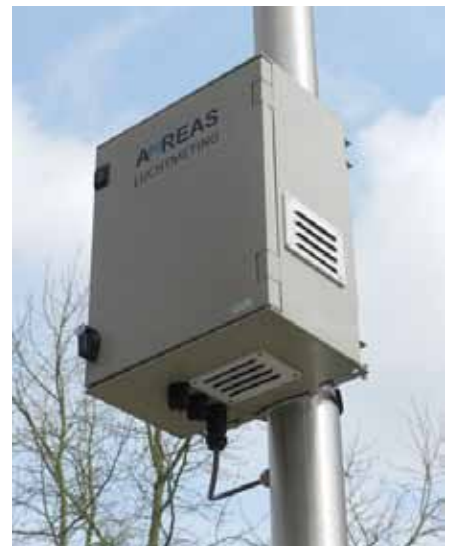
Figuur 1: AirBox, met daarin sensoren, accu en electronica voor aansturing en datatransmissie.
