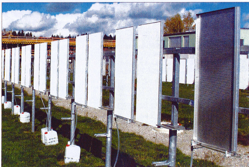
Die verkleinerten Putzflächen werden dem Wetter ausgesetzt, das an den Flächen herablaufende Regenwasser wird aufgefangen und im Labor analysiert.
