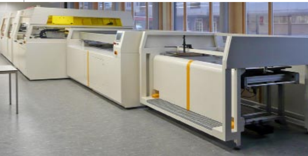
Moduleassemblagelijns voor achterzijdecontactcellen bij ECN. De lijn is gebouwd door Eurotron in Bleskensgraaf en ontwikkeld in samenwerking met ECN.
