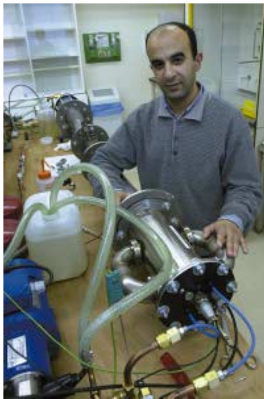
Hassan Tijani controleert de opbouw van de thermo-akoestische warmtepomp.
