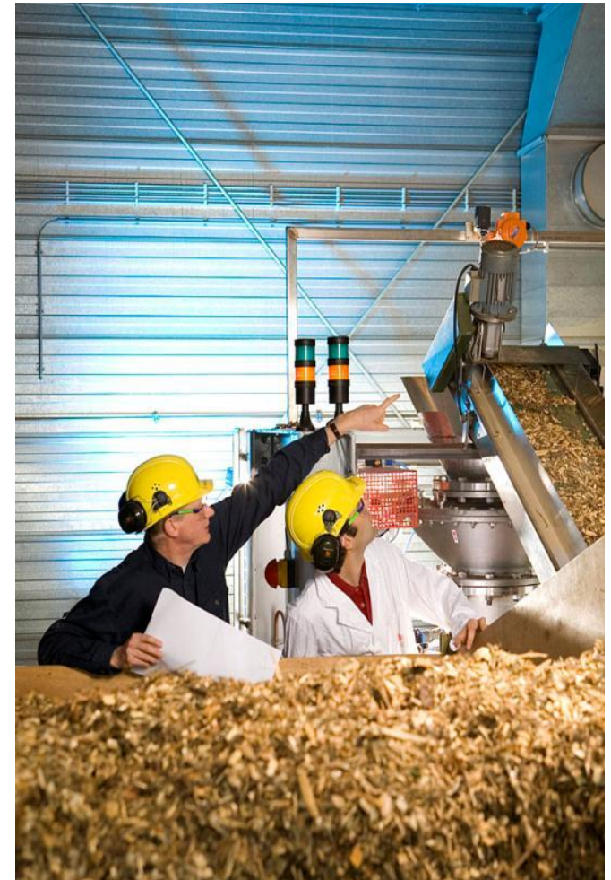
ECN 50 kg/h torrefaction pilot-plant
