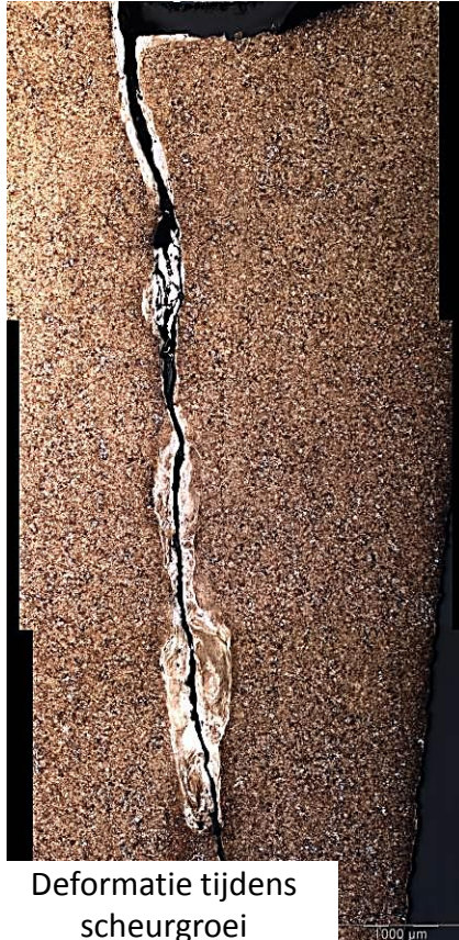
Corrosie en indicaties vermoeiing
