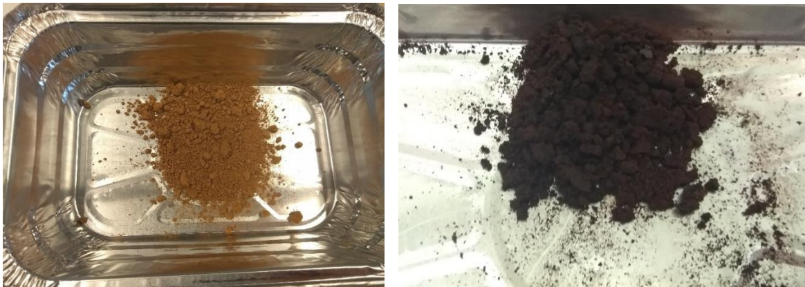
Figuur 3 Lignine voor (links) and na (rechts) verhitting (Beuk/acetone organosolv lignine uit Leuna pilot experimenten)
