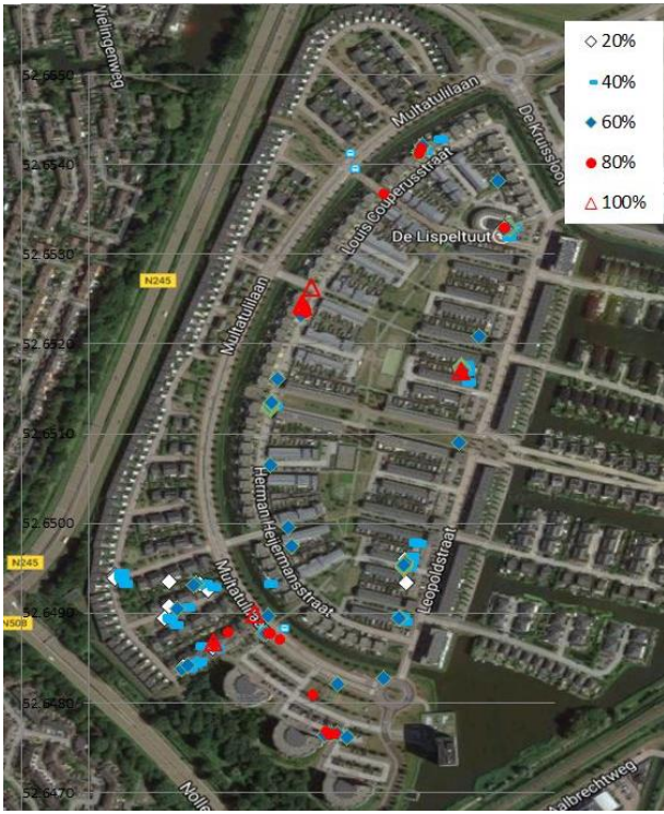
Figuur 22: Resultaat mobiele meting op 17 oktober in Vroonermeer: de concentratie van NO 2 per meetpunt als percentage van de hoogst gemeten concentratie.
