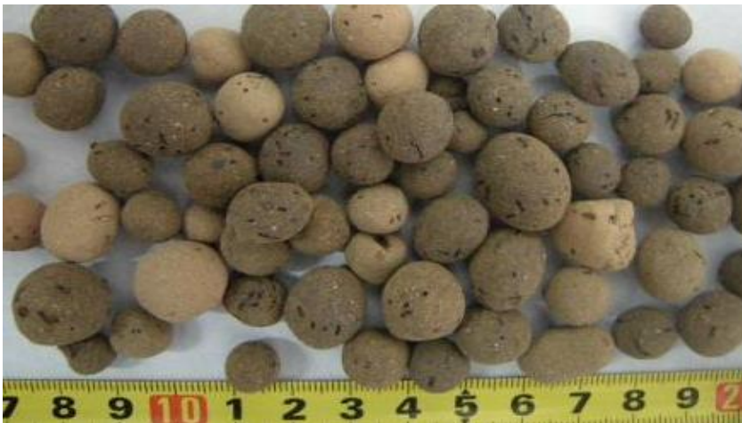
Figuur 4.1 Kunstgrind (Light-weight Aggregates, LWA) gemaakt van een mengsel van steenkoolvliegias en biomassavliegias
