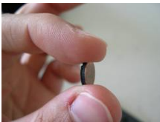
Sample van een siliconenlaag voor de meting van de thermische geleidbaarheid.
