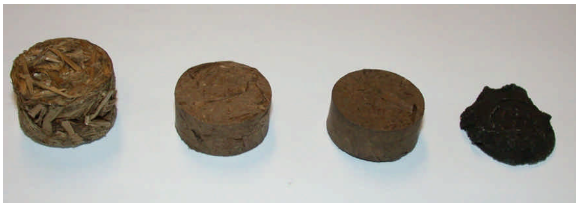
Figuur 3.1 Pellets van residu van geTORWASHt materiaal op (van links naar rechts) 150°C, 170°C, 190°C en 230°C
