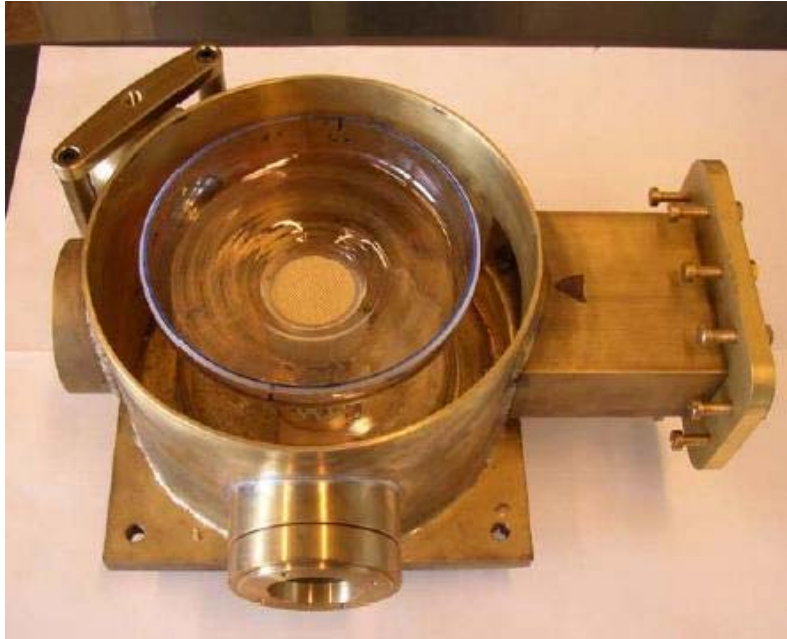
Figuur 5.7 De multimode cavity met de kwarts houder en daarin een monoliet van 4x4 cm
