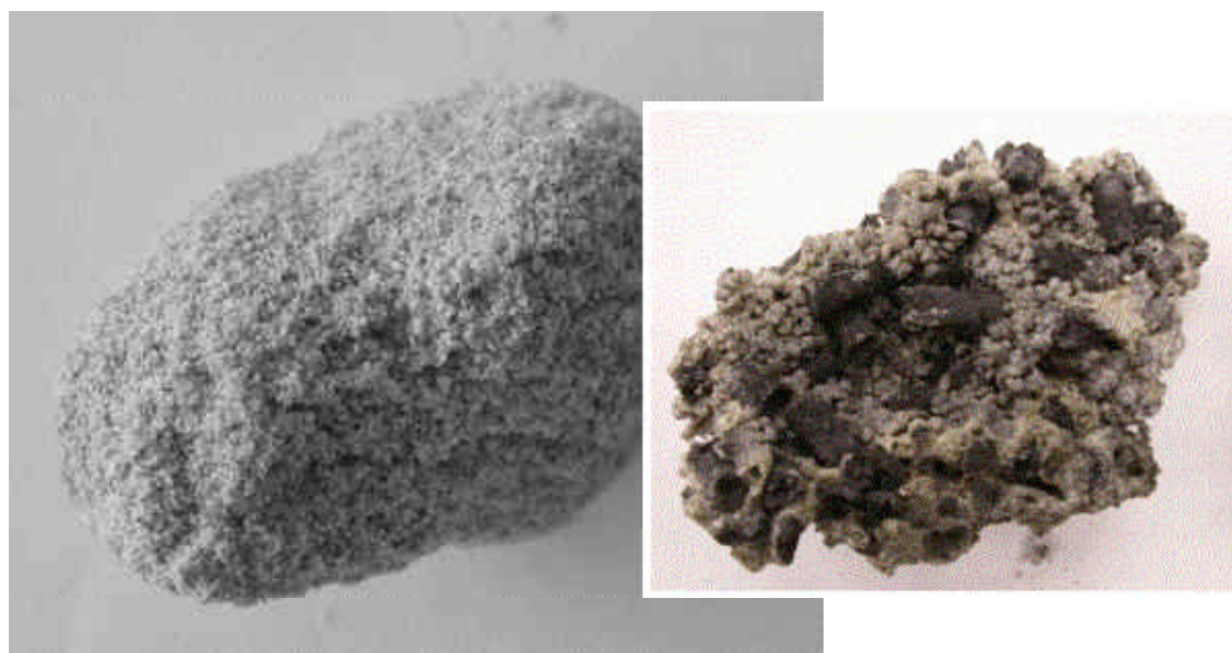
Figuur 2 Foto's van agglomeratiestructuur na afloop van vergassingstest met graspoeder (links) en graspellets (rechts) in de pilot-schaal CFB-reactor, brokken zijn enkele centimeters groot
