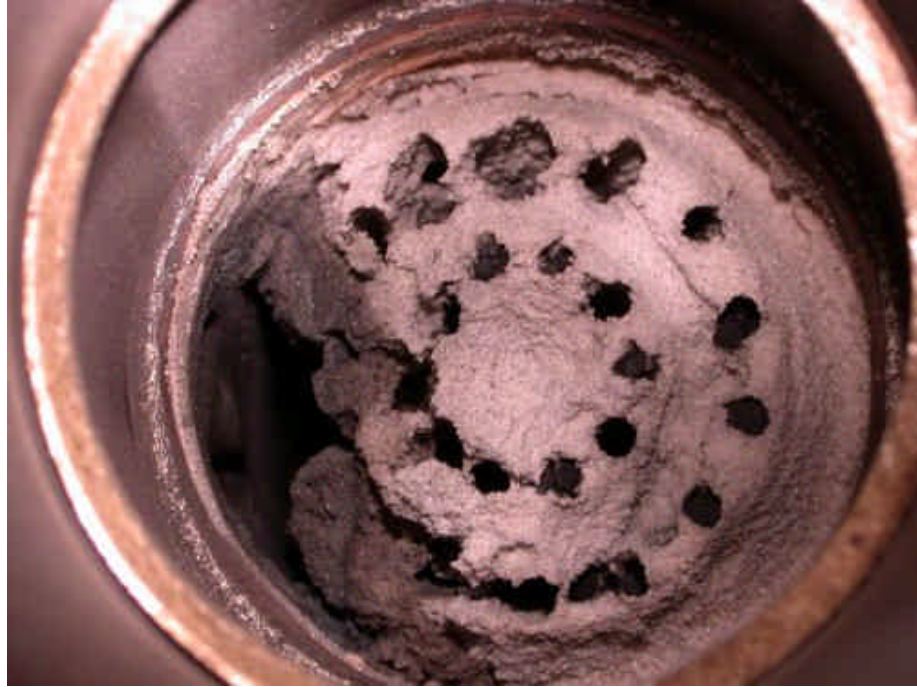
Figuur 1 Typisch beeld van geagglomereerd bed, de foto is van onderaf genomen en toont de gaten overeenkomstig met het patroon van de gasdistributieplaat
