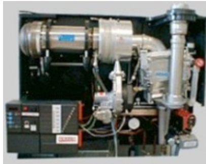
Figure 7-2 Inwendige van een Stirling \mu -WK systeem.
