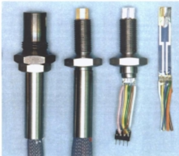
Figuur 4.4 Voorbeeld van een geïntegreerde koolmonoxide-stikstofoxide sensor voor meting in uitlaatgassen [36].
